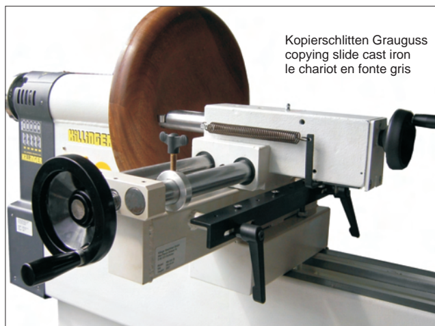
KM 2500 S mit KM 500 Querkopierwerk zum Schalendreihen KM 2500 S with KM 500 transverse copying unit for copying plates, dishes KM 2500 S avec copieur transversal KM 500 pour copiage rosettes, asiettes
