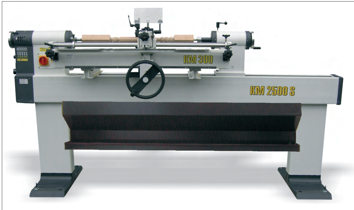
KM 2500 S mit KM 300 Längskopierwerk und Ablagewanne für Futter und Handdrechsel-Stähle KM 2500 S with KM 300 Copying Unit and tool box for chucks and turning tools KM 2500 S avec copieur universel KM 300 et bac de rangement pour outils et accessoires
